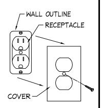
REMOVE OUTLET COVER PLATE AND PULL PLUG AWAY FROM WALL
